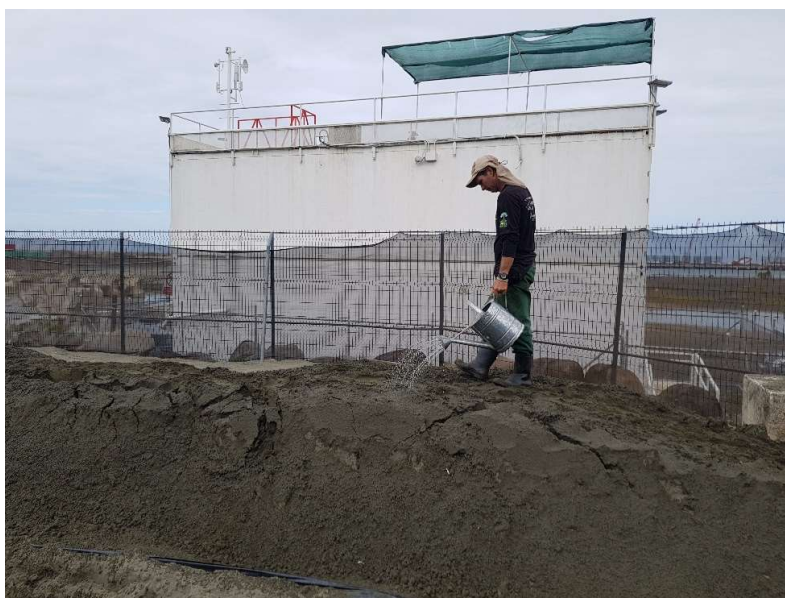
Figura 5. Aplicación de la solución de cloro al arena removida de una sección.
