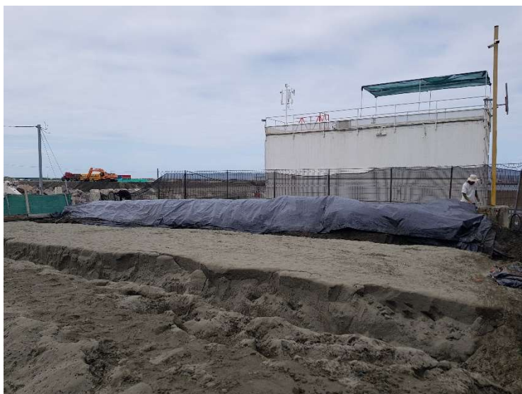
Figura 6. Arena tapada con plástico negro luego de la aplicación de la solución de cloro.
